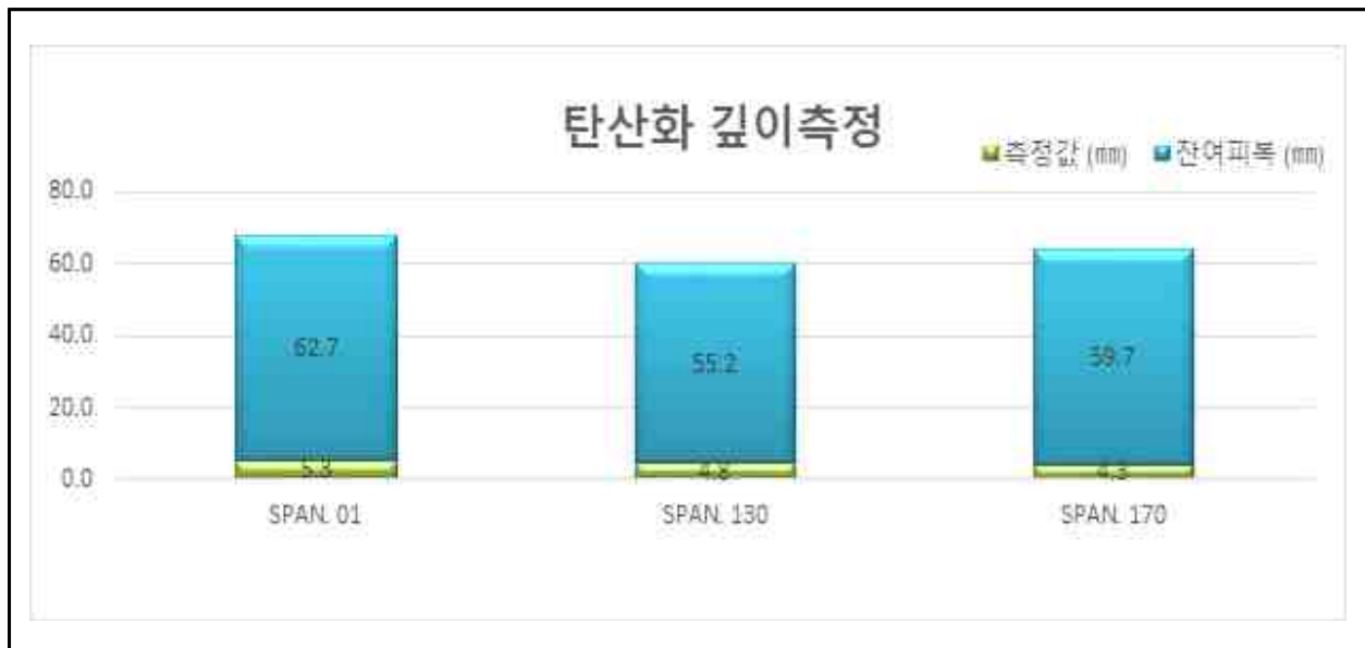
<그림 1.3.2> 탄산화 깊이측정 결과분석
