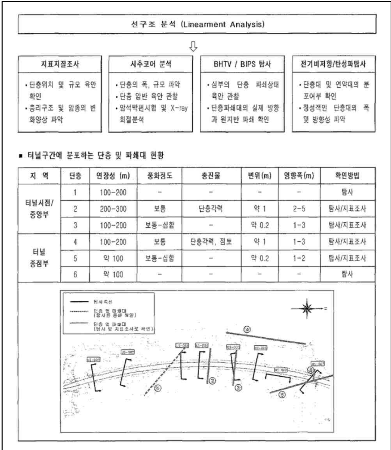
<표 1.1.7> 터널구간의 단층 및 파쇄대(2008.12) 현황
